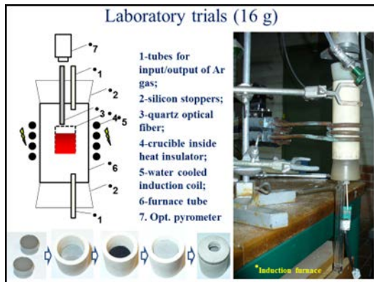
Figur 7: Molybden tillsats med oxidråvara i laboratorieskala.
