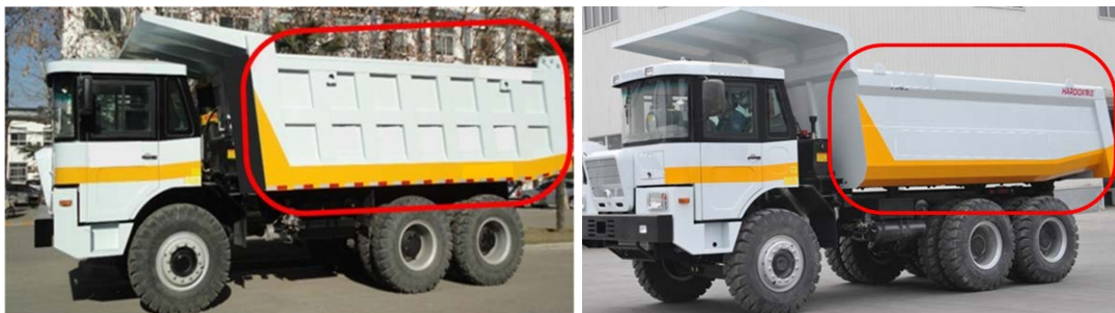
Figur 4.3. Hardox 450 ersätter Weldox 700 i flakkonstruktion. Viktsreduktion: 6000 kg till 2885 kg (52 %), Kostnadsreduktion: 47 %. (SSAB)
