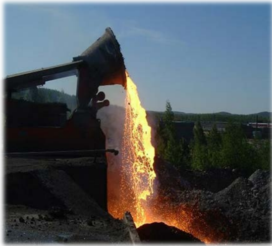
Figur 10: Varm slagg är källa till utvinning av ferrovanadin .
